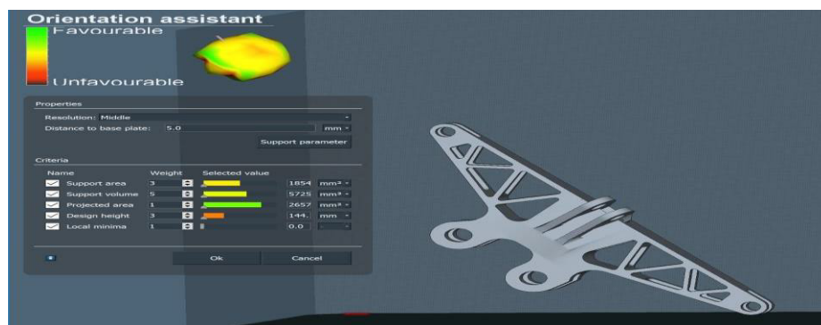
Рисунок 7 – Оптимальные положение детали для распечатки
